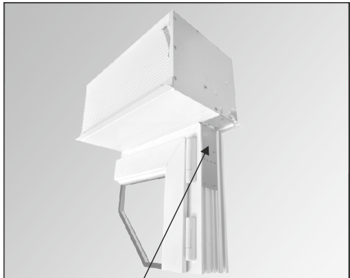
AUFSATZROLLLADEN TL1000 MIT KASTENVERBREITERUNG Min. Breite der Verbreiterung - 5,5 cm Unterhalb 5,5 cm gibt es die Kastenverbreiterung mit zulaufendem Plexiglas, in dem kein Motor einzubauen ist.
